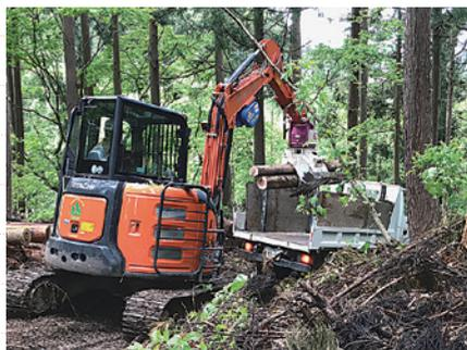
( Yunbo の先っちょの部分 ) で押して確実に倒す、なんてことも可能です。モノを掴むことができるバケットを付ければ、木を持ち上げることが出来ます。トラックへ丸太を積み込んだりするのも Yunbo は欠かせません。
